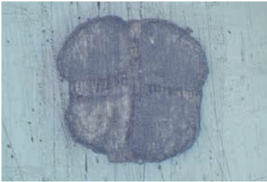
圖15 絃由四股絲線絞而成 可見光 / 50倍橫切面顯微影像 國立故宮博物院登錄保存處修護紀錄
