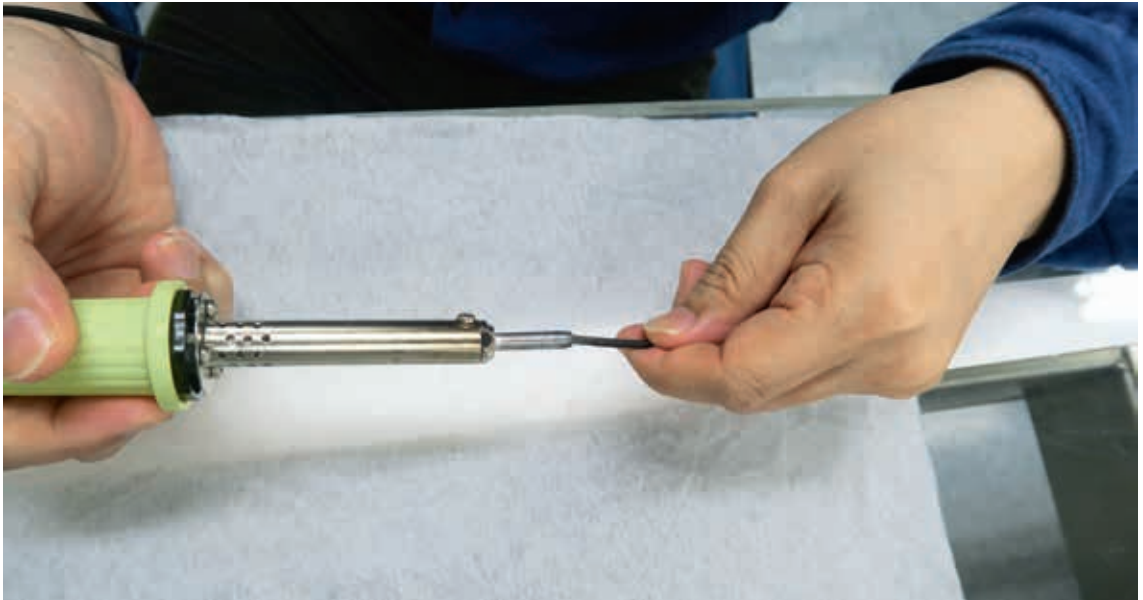
圖28 用錫焊槍加熱後於牛角圓條上塑出帽形扇釘 國立故宮博物院登錄保存處修護紀錄
