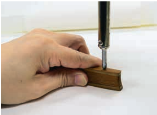
圖29 用錫焊槍加熱後於牛角圓棍上塑出扇釘 國立故宮博物院登錄保存處修護紀錄
