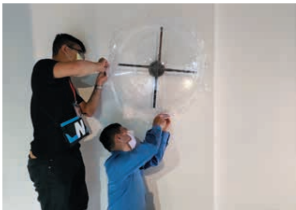
圖6 安裝LED風扇3D全息投影裝置 作者攝
