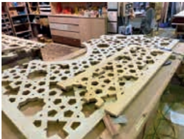
圖30 雷射雕刻工作畫面 渥得室內設計公司提供
