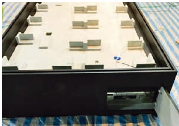
圖14 木乃伊展示櫃下右前裝置調濕機，其出風與回風必須與底板下的空間區隔，引出櫃面，不然將在底板內部自成一無效的氣流循環，圖為未封底板前之內部空間及可見支撐架。作者攝
