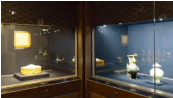
圖2 在不同的照明下同樣的壁布顯色差異。左櫃為LED燈（色溫3028K，演色性94.3），右櫃為複金屬燈為光源之光纖照明系統（色溫3648K，演色性94.9）；右櫃較左櫃更能真實呈現色彩。作者攝
