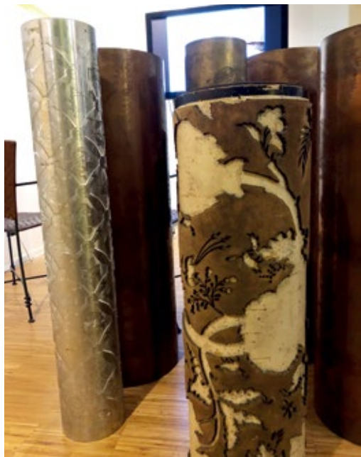
圖 13 織品銅板印刷滾筒 法國茹伊織品博物館（Musée de la Toile de Jouy）藏 作者攝
