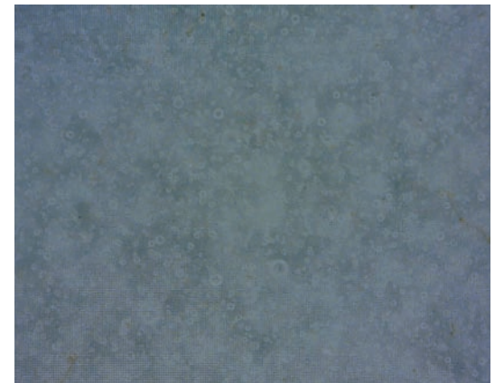
圖三 官窯圓洗釉中氣泡及乳濁形貌
