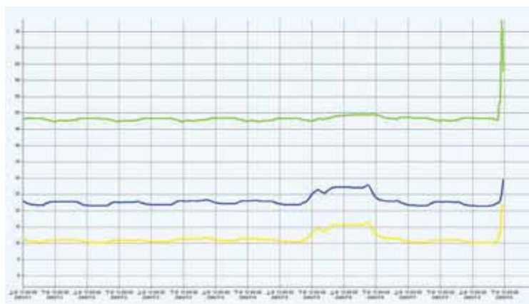
圖十一 櫃內溫度（藍線）上升，露點溫度（黃線）隨著上升逼近
