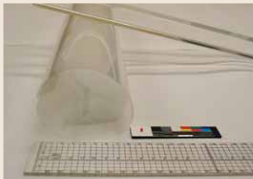
圖二二 加入無酸聚酯棉降低重量所造成的變形
