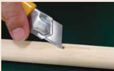
圖十八 於銅環孔洞兩側挖出凹槽
