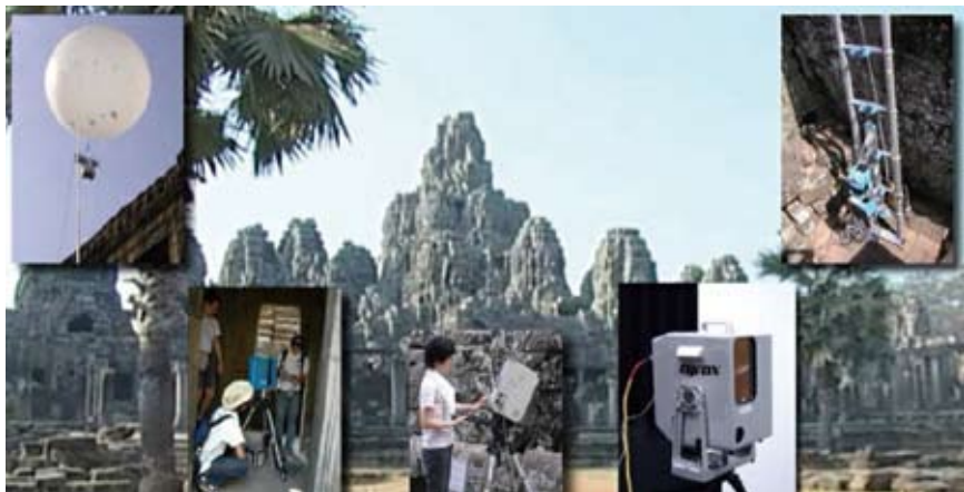
圖一 東京大學團隊利用熱氣球、攀登感應器等記錄巴戎廟的建築及局部雕刻。(Ikeuchi et al., 2007)
