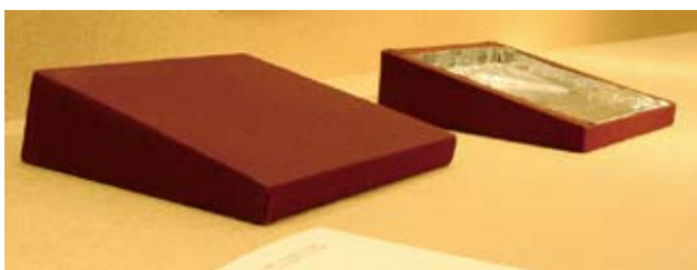
圖五 新做的墩座之封貼MarvelSeal以隔濕、防酸。
