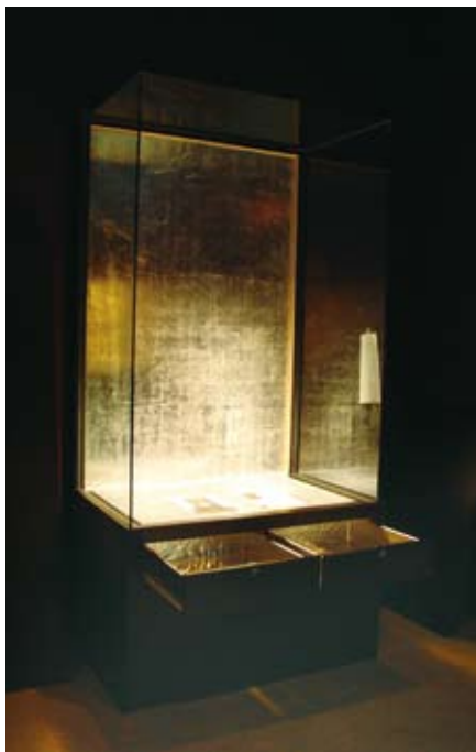
圖三 櫃體之展示面貼上MarvelSeal以隔絕濕氣及有害氣體，並於展示台下方設計有通氣縫，其下為放置乾燥劑的抽屜，同樣密貼MarvelSeal。 (沈建東提供)
