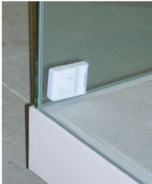
圖六 貼在展示櫃玻璃內面靈敏性極高的振動警報器報器。
