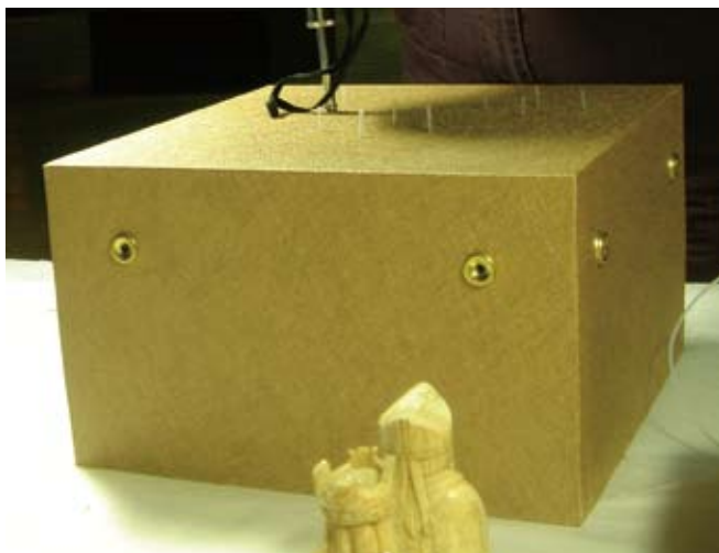
圖一 墩座挖洞、裝飾以美觀的銅鈕，再將Art-Sorb調濕劑置入墩座內
