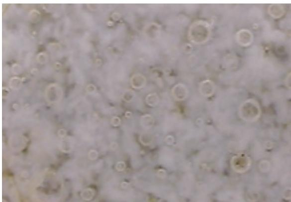
圖一 北宋汝窯青瓷紙槌瓶（故瓷004371）外底釉面顯微照
