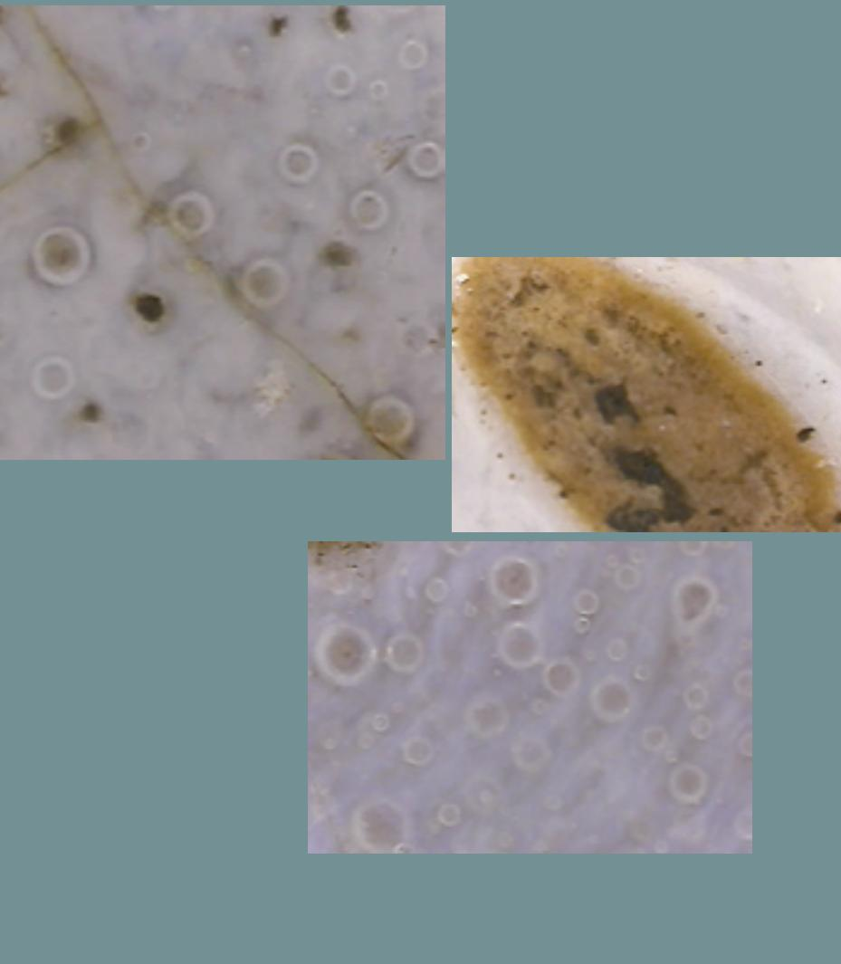
時代不同，工藝燒造的過程及使用原料的成分也就不同，各種窯燒瓷器的釉層必然存在不同的面貌，因此瓷器的鑑定除了根據器型款式、輕重、色澤來辨認，以及運用科學儀器做成分分析之外，器物表面的顯微觀察是方便又直接的方法，因為釉面上呈現的各類現象如氣泡、開片、刻痕等，亦可作為研究瓷器工藝技術及鑑定的入門。
