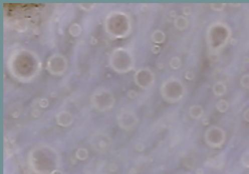
時代不同，工藝燒造的過程及使用原料的成分也就不同，各種窯燒瓷器的釉層必然存在不同的面貌，因此瓷器的鑑定除了根據器型款式、輕重、色澤來辨認，以及運用科學儀器做成分分析之外，器物表面的顯微觀察是方便又直接的方法，因為釉面上呈現的各類現象如氣泡、開片、刻痕等，亦可作為研究瓷器工藝技術及鑑定的入門。
