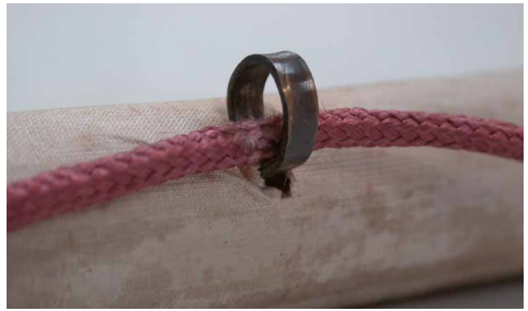
圖十一 過薄銅環磨損繩帶
