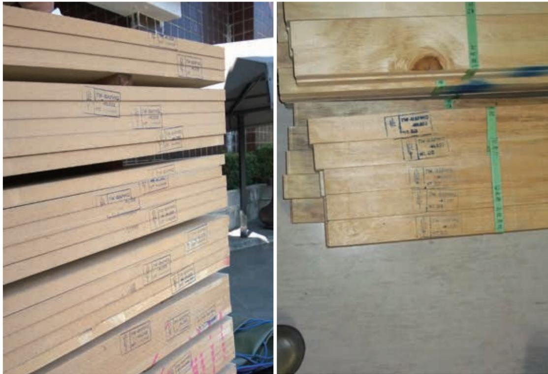
圖7 加熱完成的木板(左)與角材(右)：木板分層可增加熱對流空間，確保受熱均勻，並於處理後加蓋加熱處理章戳。 作者攝
