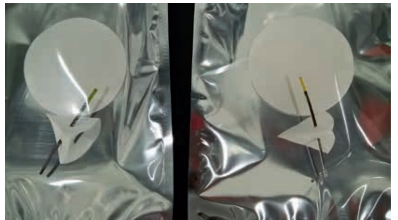
圖4 兩種白膠的檢測結果比較：實驗結束試片呈現一綠一黃，綠色代表酸鹼中性，黃色代表偏酸。作者提供
