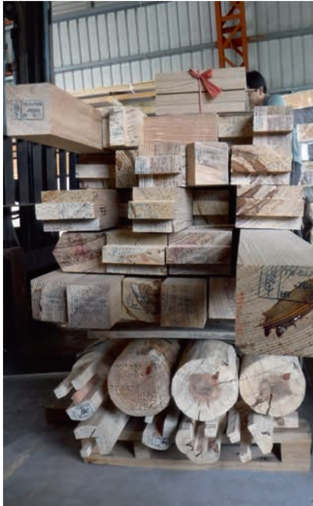
圖5 南院茶文化展廳明代茶寮的木料已結束加熱程序，待抽驗合格後進行加工。作者提供
