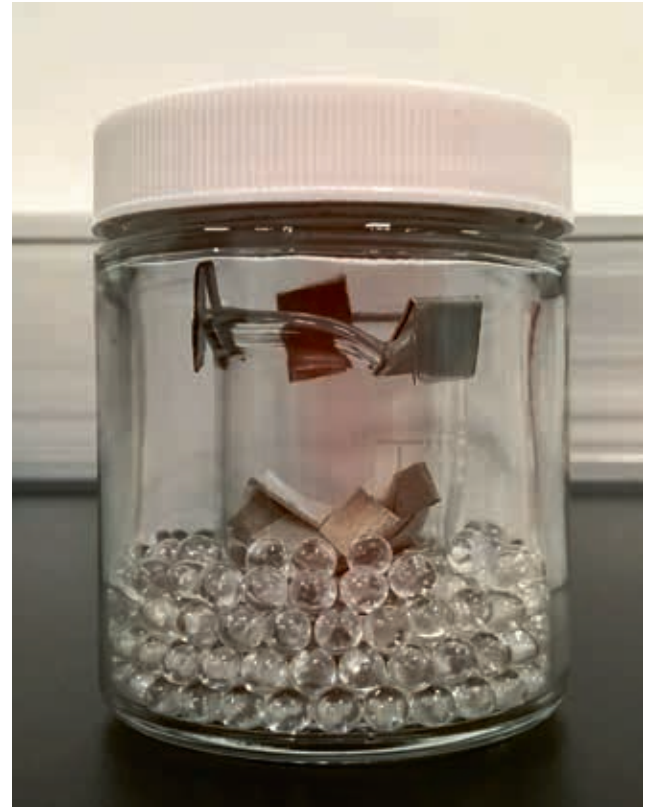
圖7 奧迪測試：罐內燒杯內為測試樣本，金屬片掛於杯緣，杯罐間以玻璃珠固定，避免移位。 作者提供
