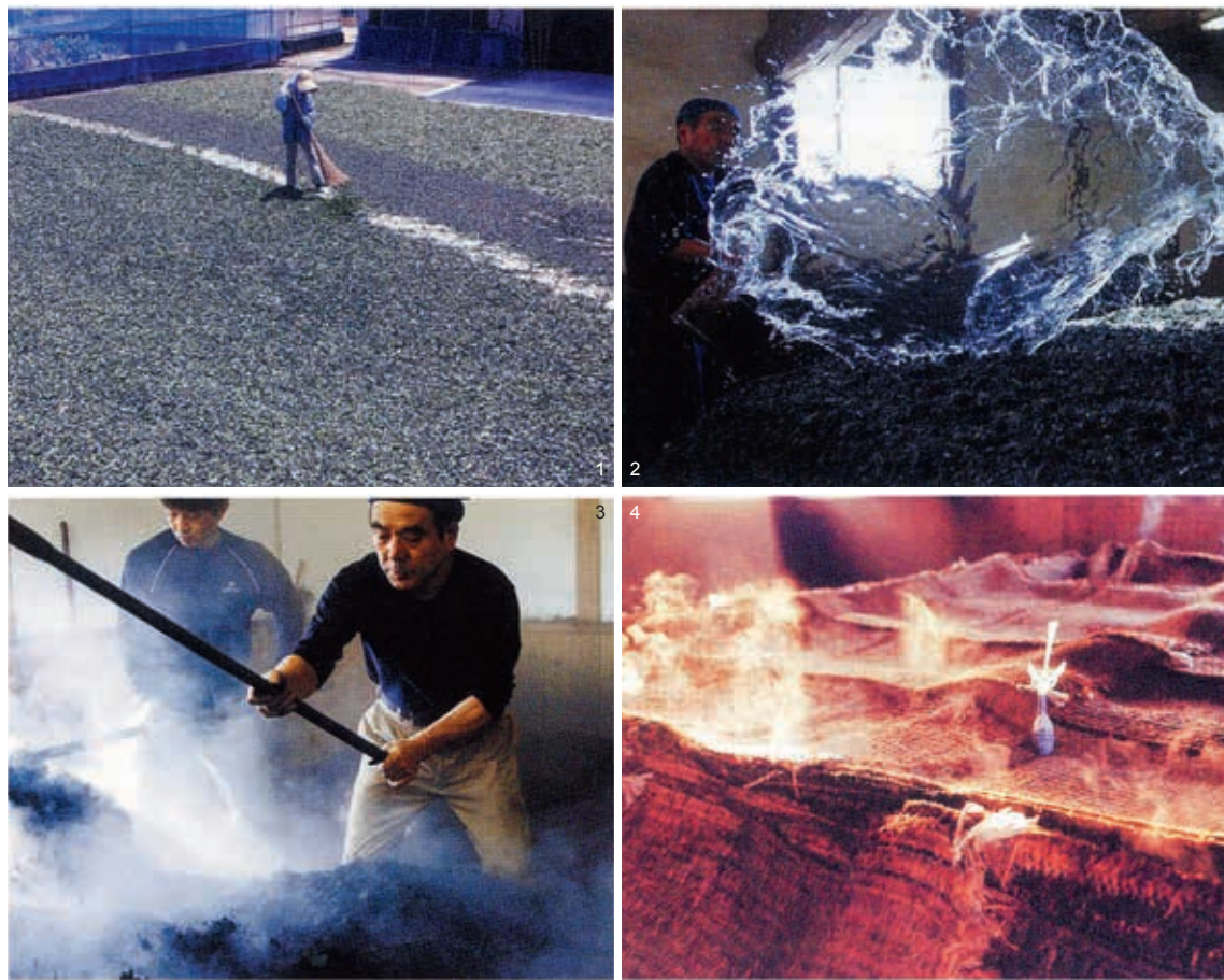
圖14 現今德島藍師製藍景況：1.翻曬、2.瀉水、3.攪拌、4.保溫靜置 引自馬芬妹主編，《藍的禮讚—臺灣藍×阿波藍國際交流展專輯》，頁104。新居修提供
