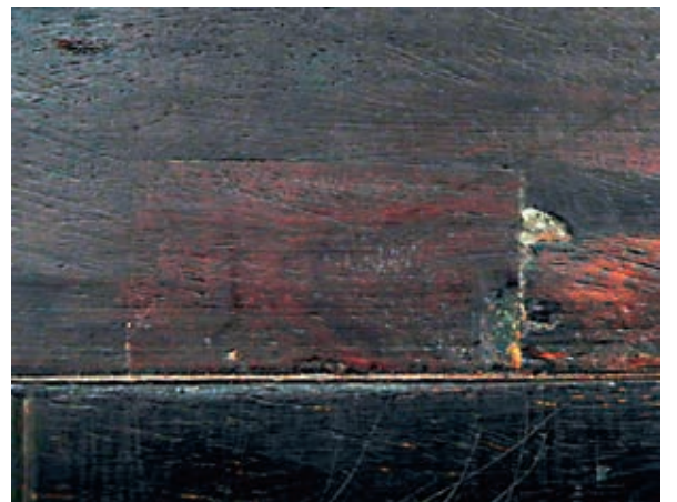
圖5 紫檀板料於木材缺陷處的拼接情形 登錄保存處修護紀錄
