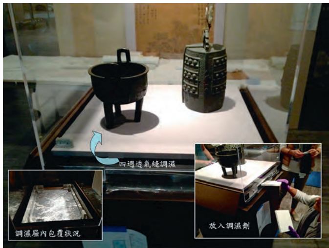
圖7 赴美展展6月7日進行宋代〈政和鼎〉及〈夷則鐘〉的佈展。這兩件銅器是同時放置在一獨立櫃內，櫃內台下抽屜大的空間，放入35-45%的矽膠調濕劑(GORE-TEX Silica Tile)，展櫃設定維持在40% RH左右。 作者製
