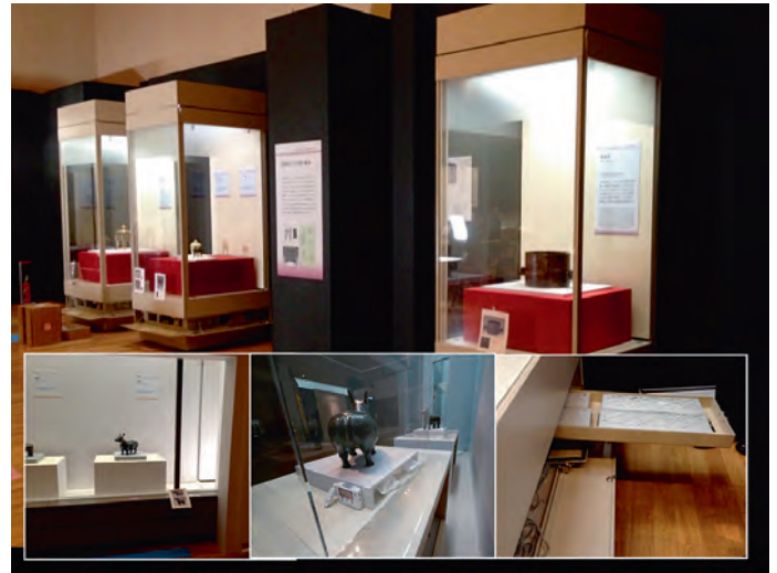
圖8 2014年赴日「神品至寶」展青銅器展櫃的調濕劑檢查及改善。左下為進行通櫃佈展，下中為〈轆轤〉加罩及降濕作業。右下為獨立櫃下放置調濕劑。 作者製
