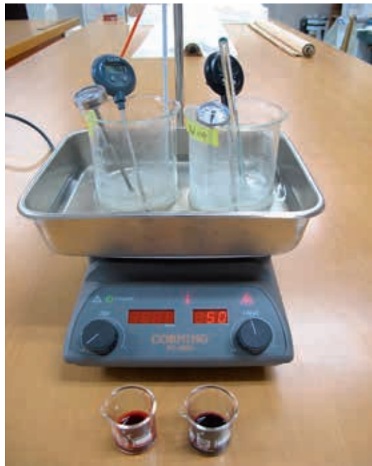
圖二一 按染絲溫度過程逐次升溫，加入媒染劑。 登錄保存處修護紀錄
