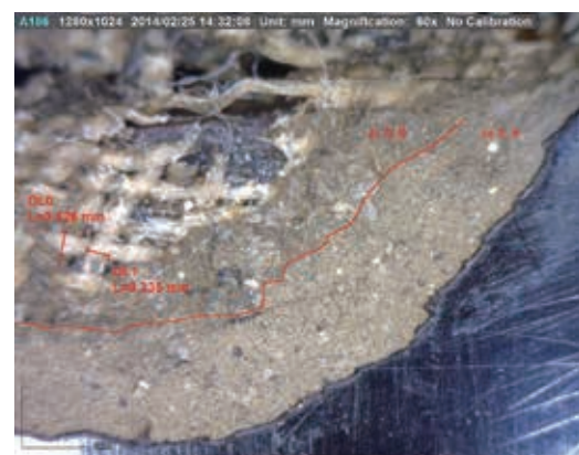
圖五 〈嵌玉木匣〉黑漆塗層部位顯微攝影，可觀察到塗膜的結構，由底面至表面分別為木胎、固胎漆膜、裱布層、粗灰地仗層、細灰地仗層以及黑漆塗層。登錄保存處修護檔案照片
