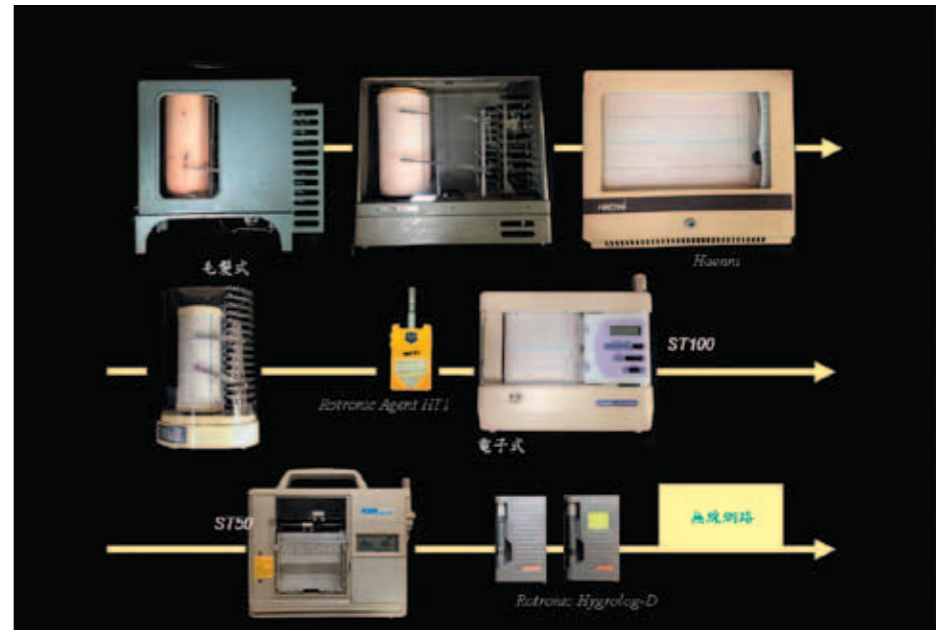
圖五 本單位歷來使用溫濕度記錄器的演變過程
