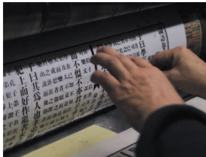
圖十二 墊板，在滾筒對應位置適度增補厚度。 作者攝
