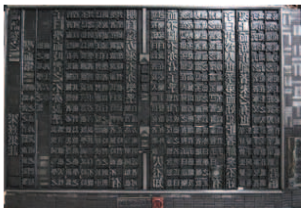
圖六 完成後的活鉛字版，與右側母本對照呈現反字鏡射編排的趣味 作者攝
