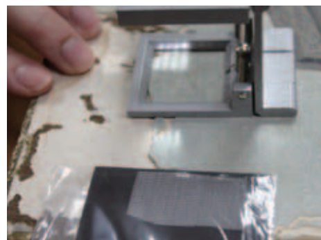
圖十八 在2.7cm²放大鏡下，觀察原有綾布之經緯線組織，以決定選擇適當補絹。
