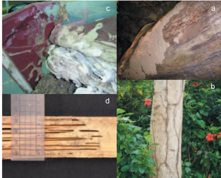
圖三 地下白蟻所建之泥板(a)和泥道(b)；(c)為害之物件及隧道表面通常佈滿髒污；(d)偏好取食春材部位，留下較硬的夏材。
