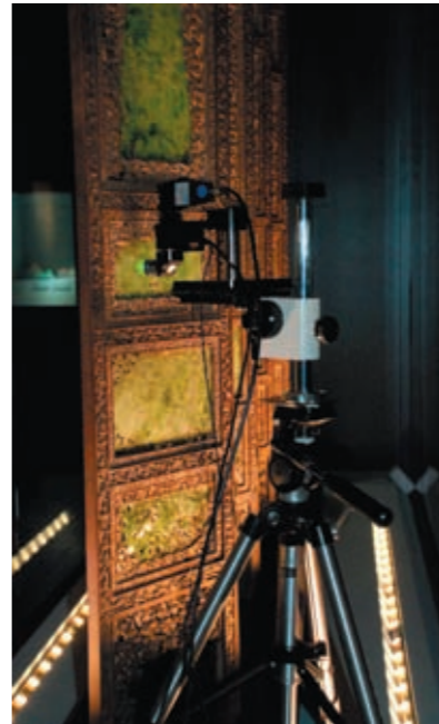
圖四 利用可攜式拉曼光譜儀檢測嵌玉屏風
