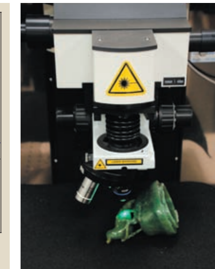
圖一 利用拉曼光譜儀檢測翡翠雕花鳥瓶（中玉626）壺蓋
