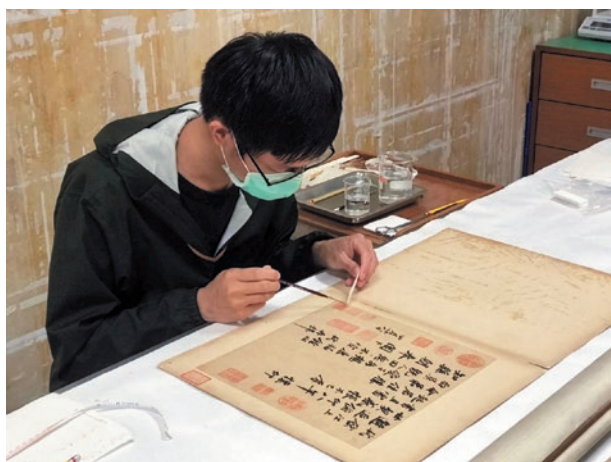
圖 10 進行媒材點測，測試文物之媒材是否會掉色。國立故宮博物院登錄保存處修護紀錄
