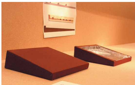
圖 2 2007 年「世界文明瑰寶——大英博物館 250 年收藏展」於新的木製墩座貼貼 MarvelSeal ® ， 3 較常用黏著劑貼合的工法，更具隔濕、防酸的優點。 作者攝
