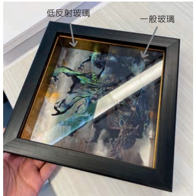
圖3 一般玻璃與低反射玻璃對於反射倒影之效果比較，燈管於兩種玻璃上的反射倒影存在明顯差異。李宥欣攝
