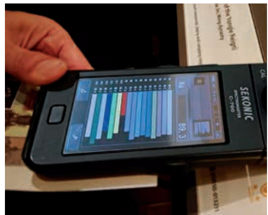
圖 5 於本院正館文獻展廳實測的結果，表現紅色的演色性 R9 較為欠缺。林姿吟攝
