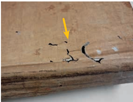
圖8 蟲蛀孔造成結構不完整 國立故宮博物院登錄保存處修護紀錄
