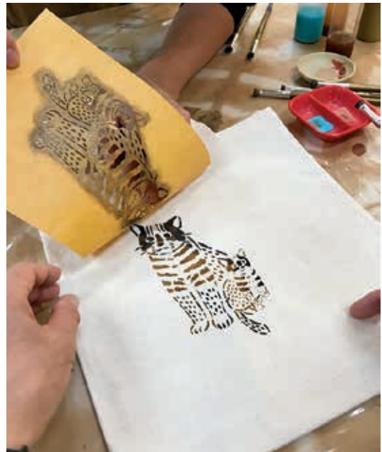
圖 18 新埔柿染體驗，使用柿汁和醋酸銅（媒染劑）刷染覆蓋於棉布上的型紙，型紙鏤空的部分則會出現圖案。 筆者攝於 2020 年 12 月
