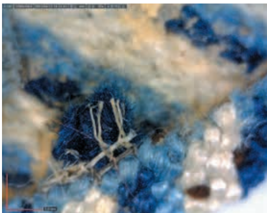
圖 2-1 絞經紗顯微放大 65 倍，可以看出經線左右兩條互相絞轉一次。 國立故宮博物院登錄保存處修護紀錄
