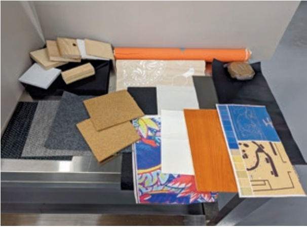
圖 5 裁切後送驗的待測物：板材、織品、片膜、發泡材、紙與其他類固定形態之材料。 作者攝
