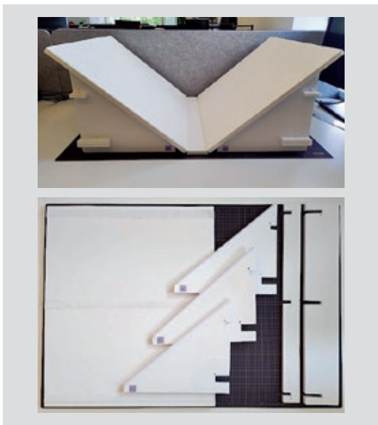
圖 2 測量用托架 © 自光體室內裝修設計有限公司提供
