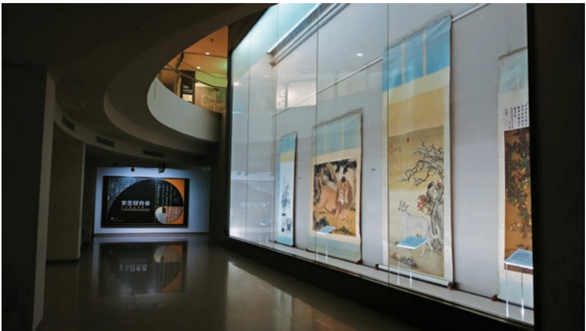
圖 4 展示大畫的展櫃，低展臺、高壁板，燈光高顯色、低照度，壁上有安裝掛畫軌道，可展示巨幅作品。 作者攝
