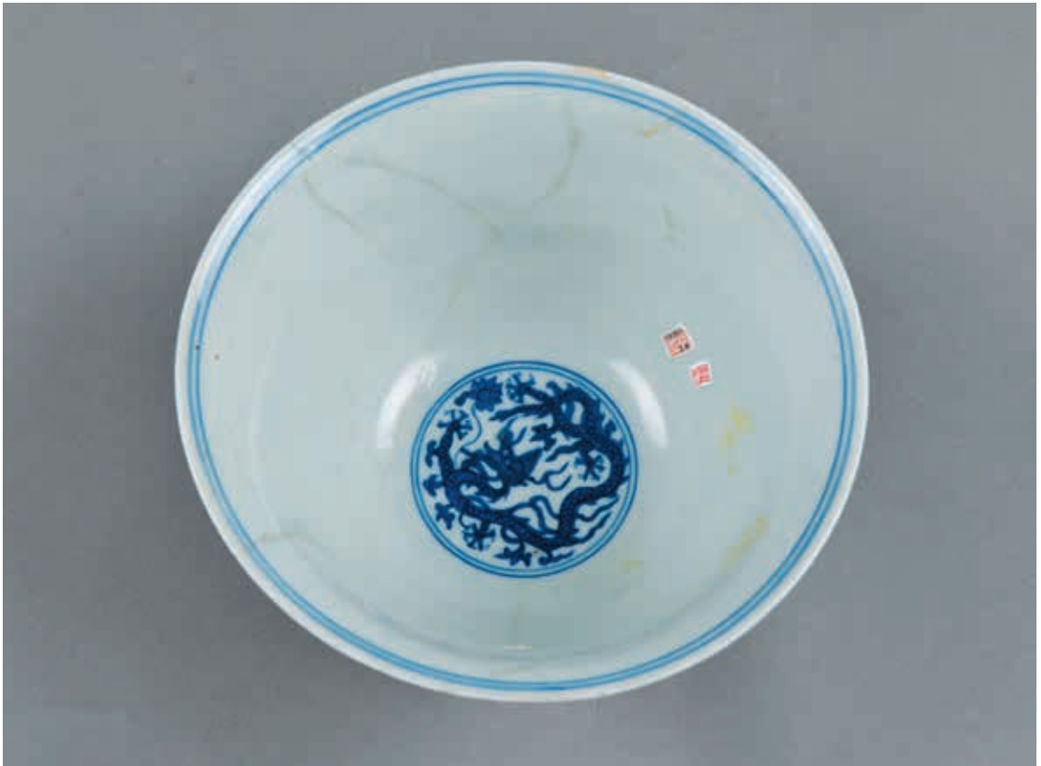
圖 1 70 至 80 年代常見使用舊款環氧樹脂導致黃化變色之狀況 作者攝
