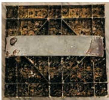
圖12 印尼蠟染銅製模具 作者攝
